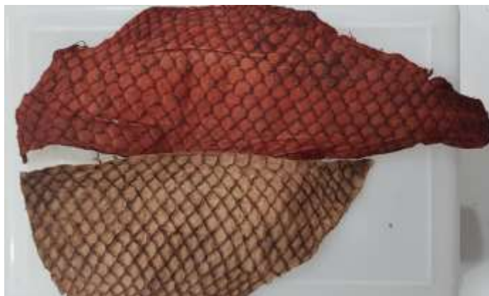
Figura 2. Couro de tilápia fabricado no processo de curtimento.
