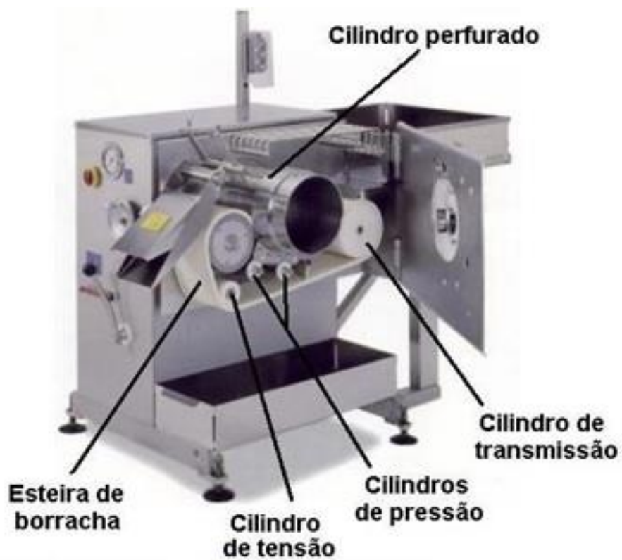
FIGURA 6. Separadora de ossos Belt-and-drum ou tambor rotatório feito de aço inoxidável (Adaptado de Kotaki ,2005).
