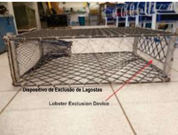
Figura 6. Uma janela de escape de lagosta é mostrada na parte traseira do Eco-covo, e a janela de escape de peixe está próxima aos tubos de alumínio no painel frontal.
