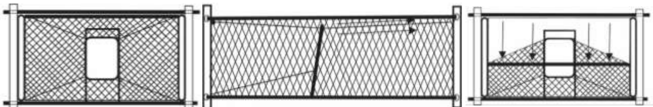
Figura 22. Posicionamento modificado do painel de abertura da armadilha “sanga tipo 2” do AGFD fixado com fios biodegradáveis, colocado na parte frontal do dispositivo, e o novo formato da moldura de entrada do dispositivo (sanga).
